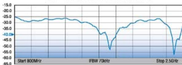
S21 TYPICAL INSERTION LOSS(dB)
